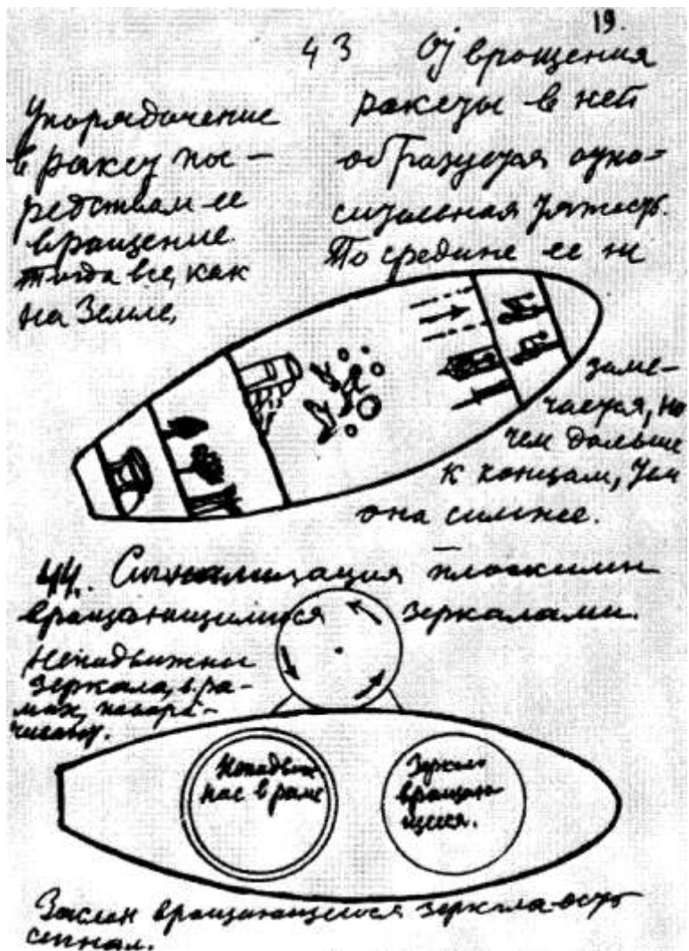
Создание на борту орбитальной станции искусственной тяжести путем ее вращения («Альбом космических путешествий»)
